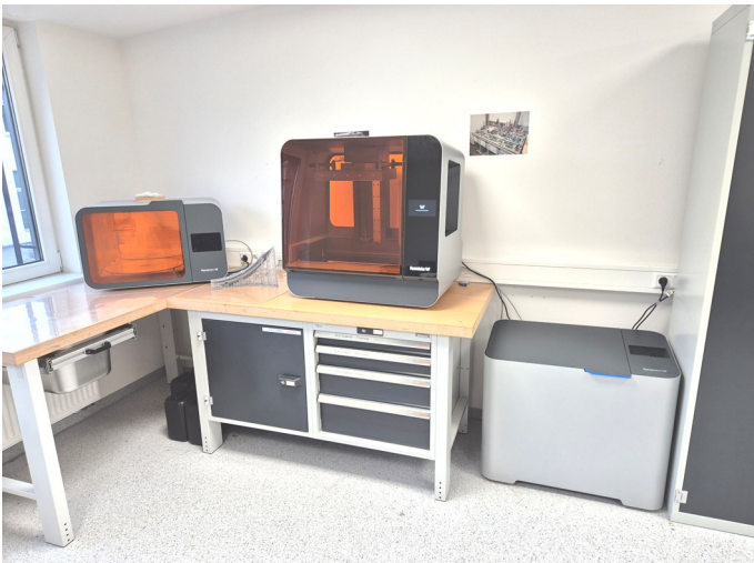
Formlabs Form 3BL SLA 3D-Drucker mit Nachbearbeitungsstationen Form Wash L und Form Cure L
