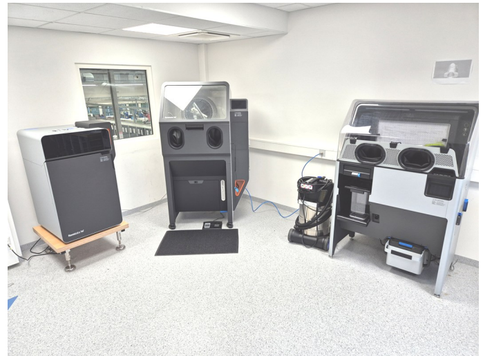
Formlabs Fuse 1+ 30W mit Nachbearbeitungsstationen Formlabs Fuse Blast und Formlabs Fuse Sift
