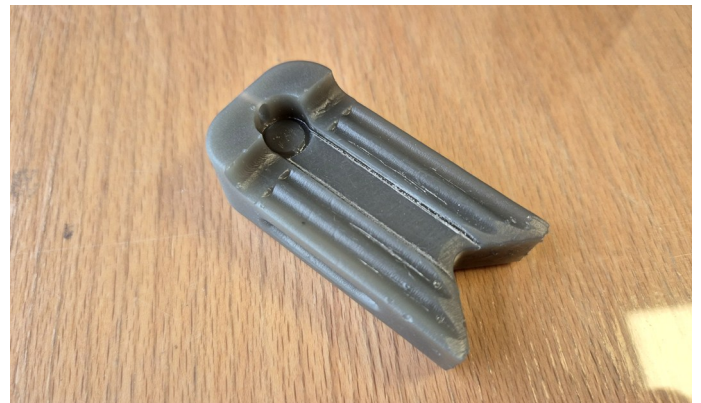
Ein Teil der Montagehilfe aus Formlabs Tough 1500 Resin, mit wellenförmiger Führung, zur Reduzierung der Kapillarwirkung zwischen den Teilen.
