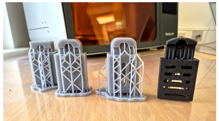
Ein Teil der Montagehilfe aus Formlabs Tough 1500 Resin, mit wellenförmiger Führung, zur Reduzierung der Kapillarwirkung zwischen den Teilen.
