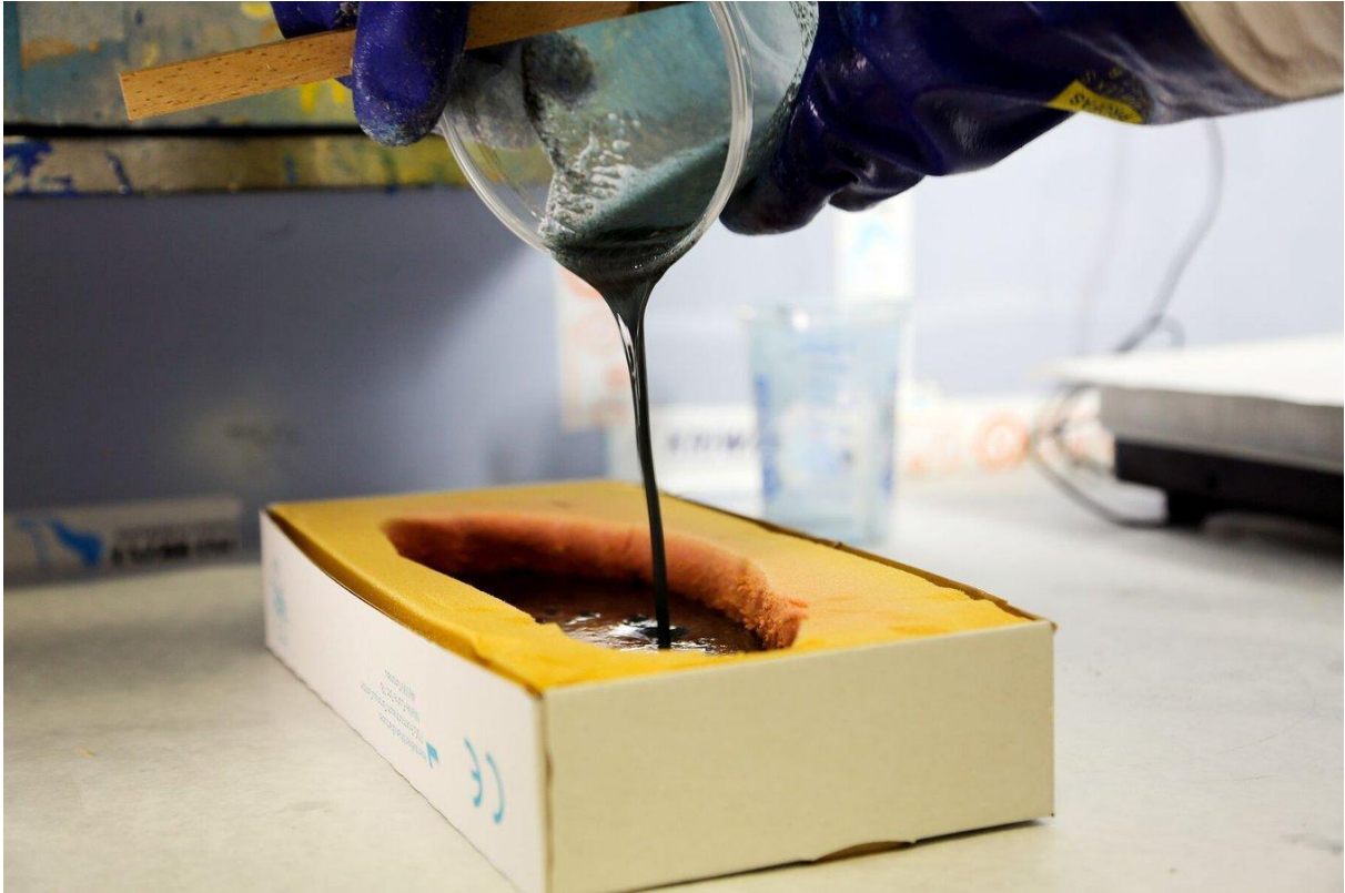
Anschließende Füllung des Abdrucks mit Chemikalien zur Nachbildung des Fußes
