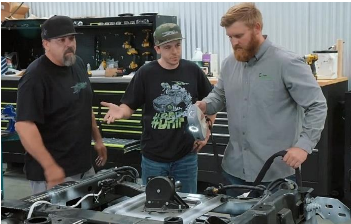
Jack Fisher nimmt 3D-Aufnahmen mit dem Artec Eva 3D-Scanner auf
