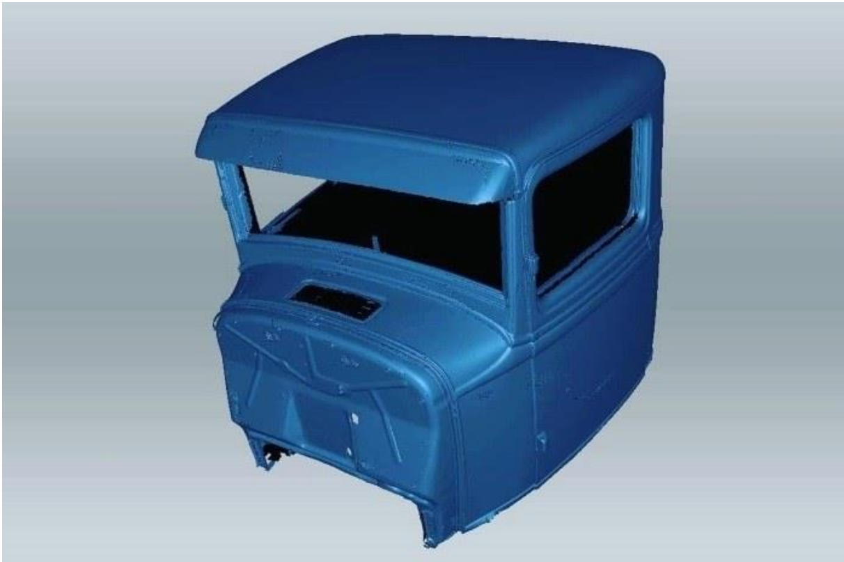
3D-Scan eines '33 Ford-Fahrerhaus für eines der SEMA-Projekte von Tekk Consulting, erfasst mit dem Artec Eva
