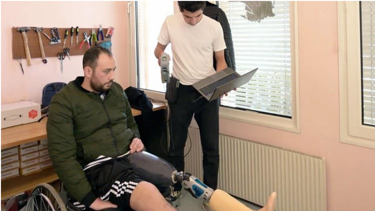
3D-Scan der Patientenmaße für die Fertigung individueller Prothesenschilde mit dem Artec Eva 3D-Scanner
