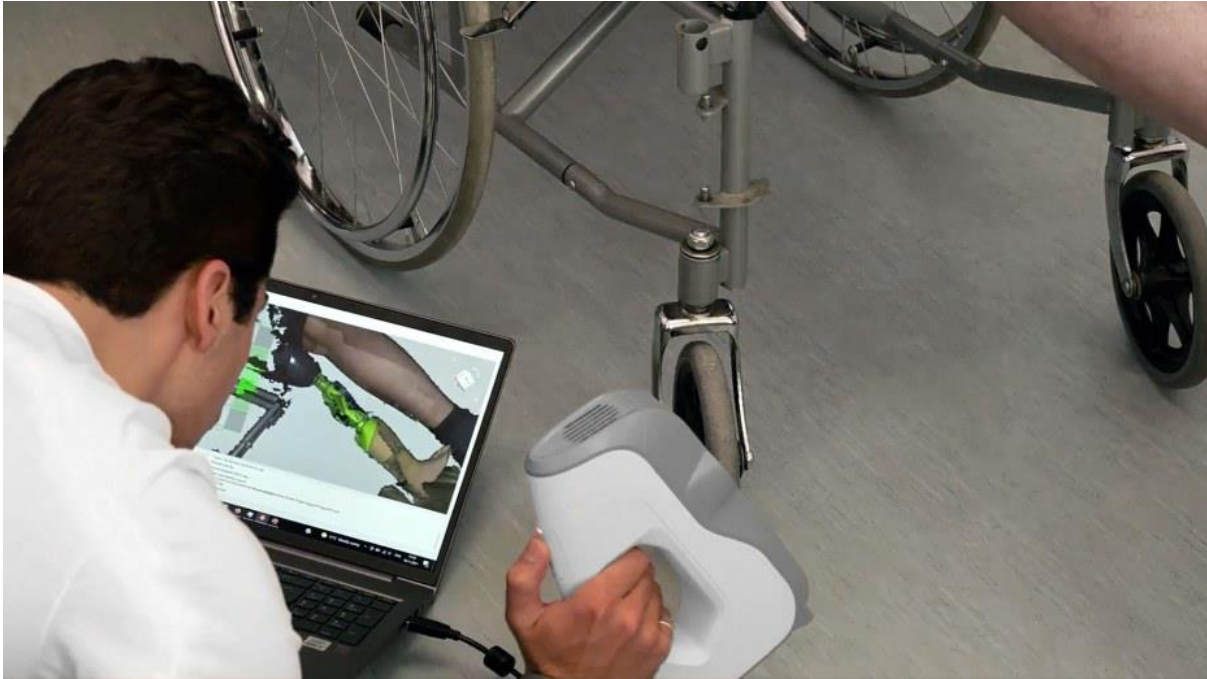
3D-Scanning eines Patienten für die Entwicklung einer maßgeschneiderten Prothese
