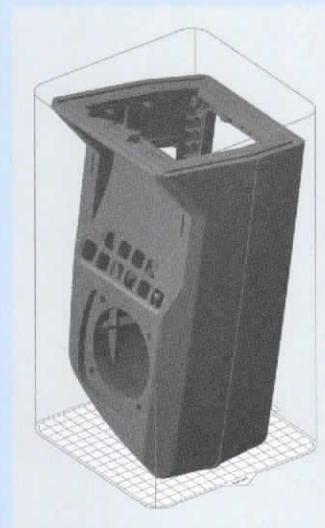
Druckvorbereitung – Platzierung der Armlehne im Bauraum des Formlabs Fuse 1 3D-Druckers.
