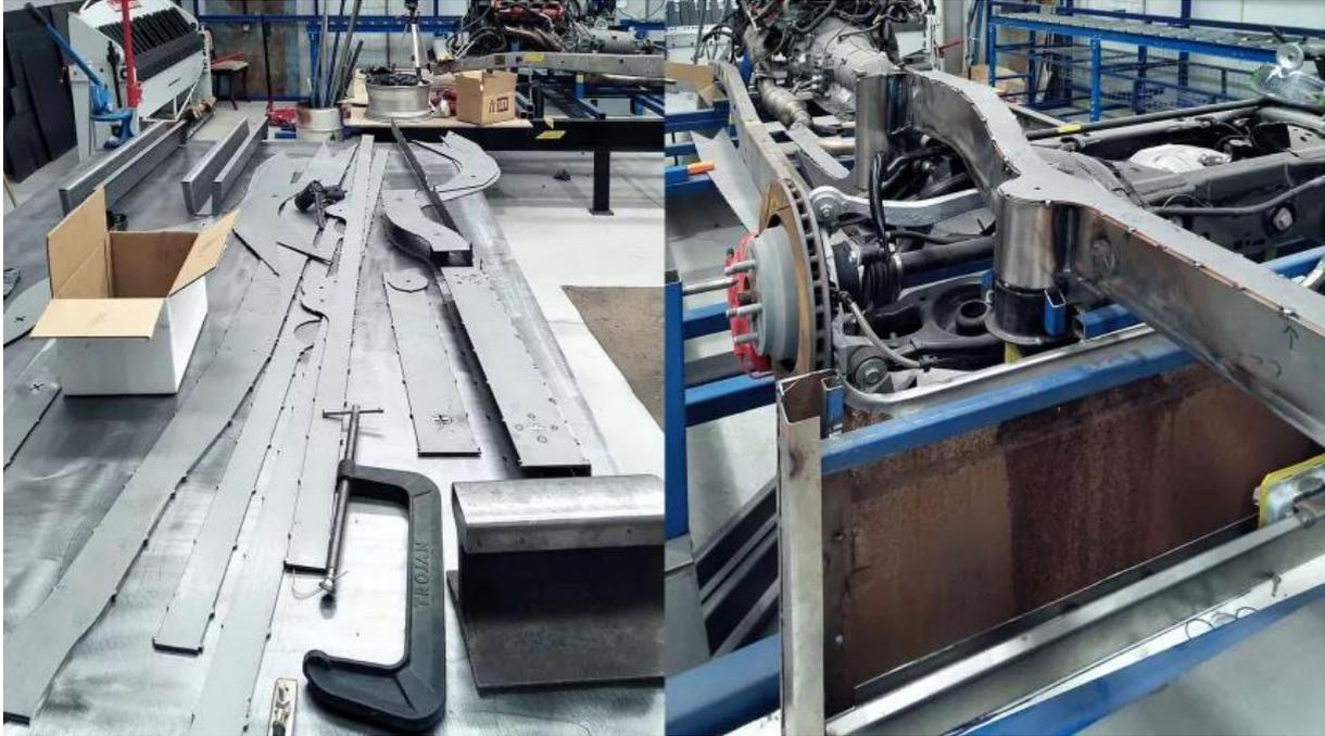
Neue Karosserieteile des Vans, hergestellt mittel Laserschneiden (Bildquelle: streetmachine.com.au)
