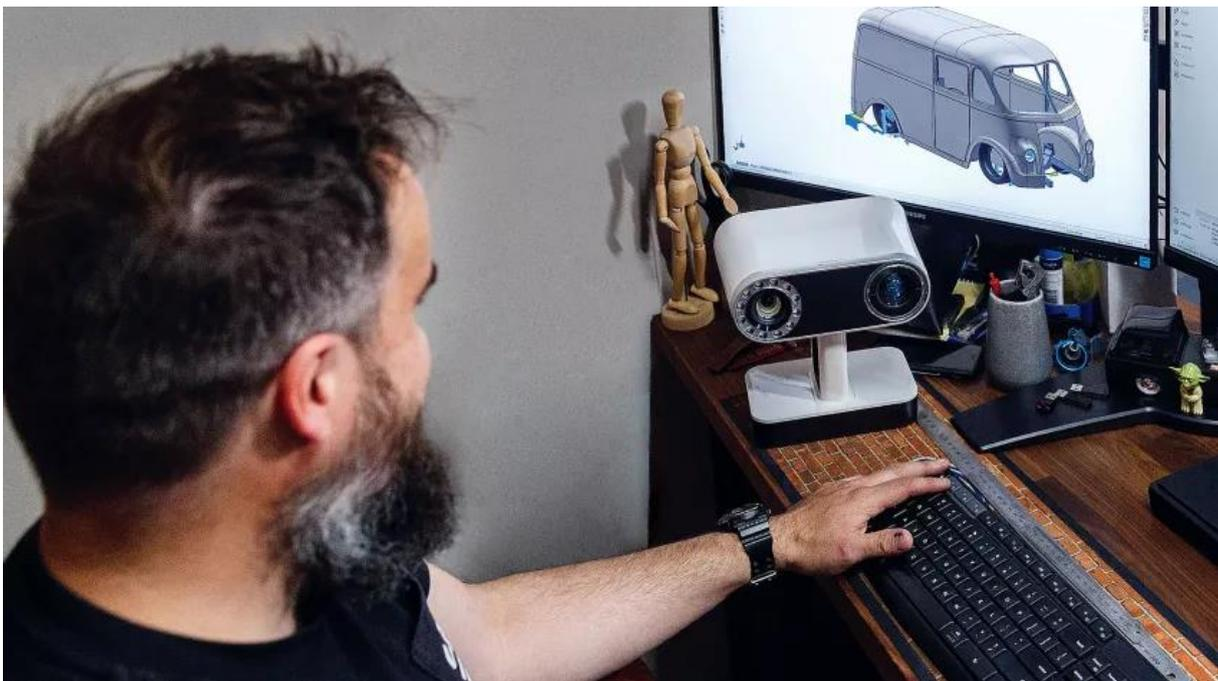
Aus den Scandaten werden Skizzen erstellt mit denen in der Software Autodesk Alias die neue Karosserie modelliert wird (Bild: streetmachine.com.au)
