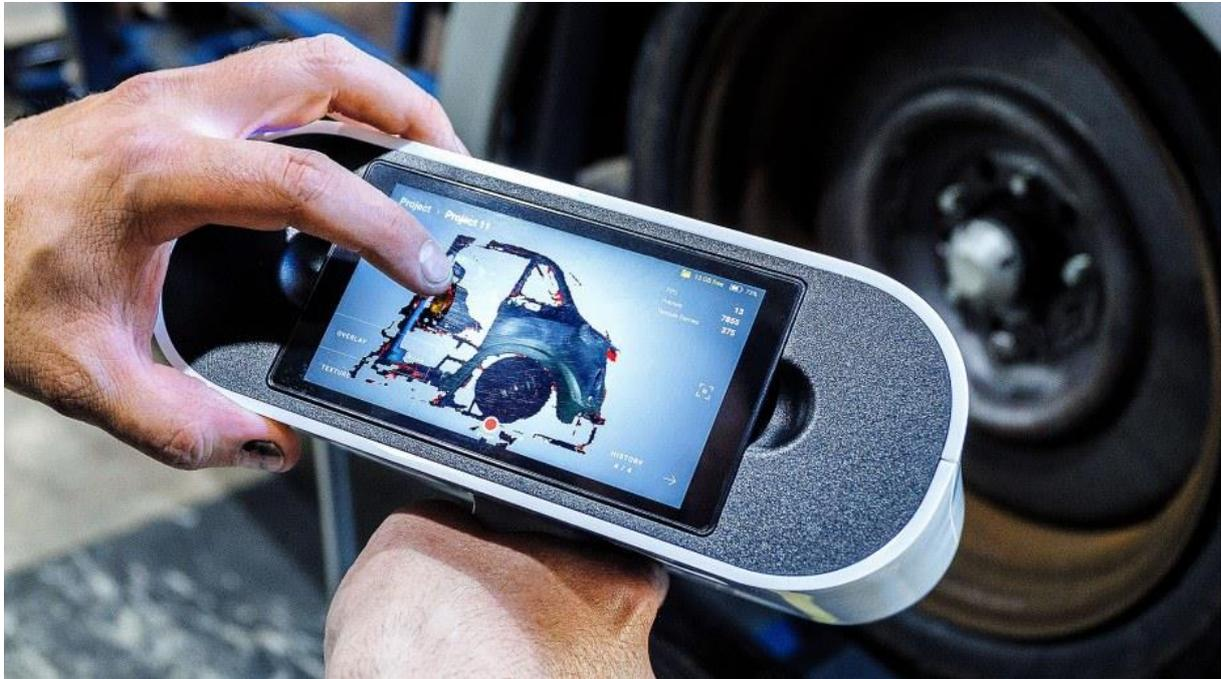
Das integrierte Touch-Display des Artec Leo gibt in Echtzeit Rückmeldung zum Scanvorgang (Bildquelle: streetmachine.com.au)
