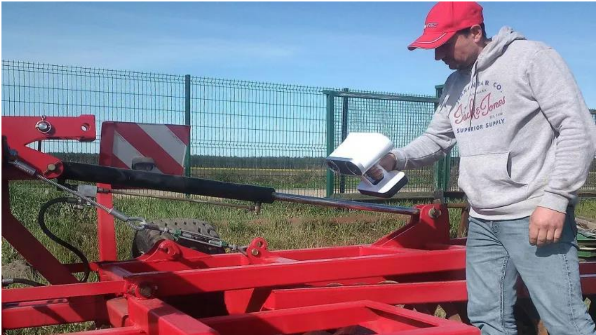
Scanvorgang einer Landmaschine mit dem kabellosen 3D-Handscanner Artec Leo (Foto mit freundlicher Genehmigung von Agri Techni Concept)
