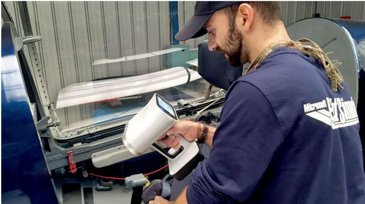
*3D-Scanning des Flugzeuginnenraums mit dem Artec Leo von einem Fahrzeugkonstrukteur bei Asobo Studios*
