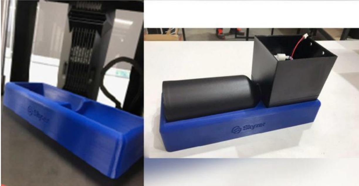
*Auf den Raise3D Pro3 3D-Druckern hergestellte Montagevorrichtung zur Montage des berührungslosen Seifenspenders von TwoGood*
