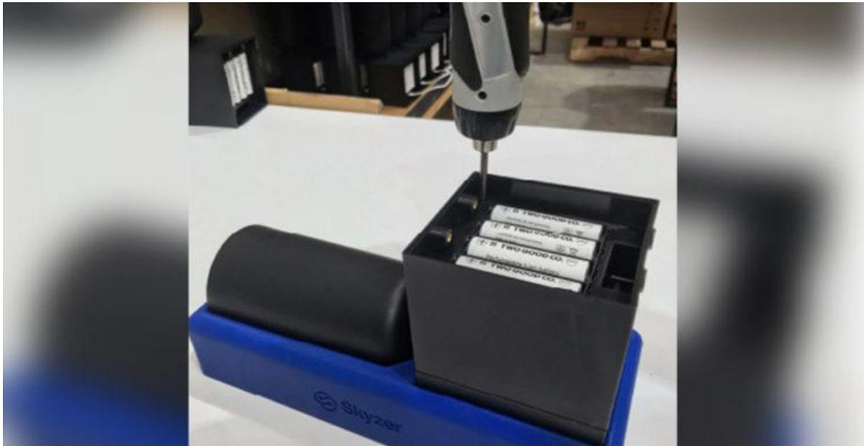
*Individuelle Schablone für eine simple Produktmontage hergestellt von Skyzer mit den Raise3D-Druckern*
