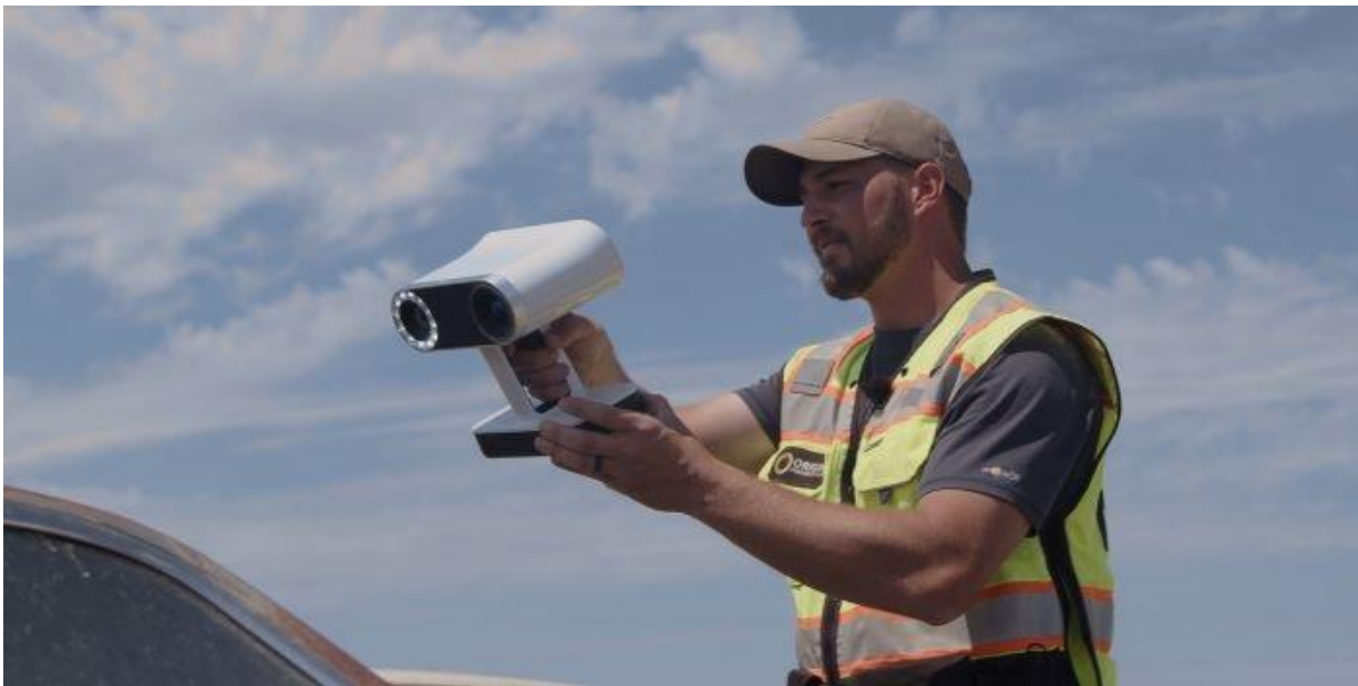
3D-Scan eines Fahrzeugs mit dem Artec Leo 3D-Scanner
