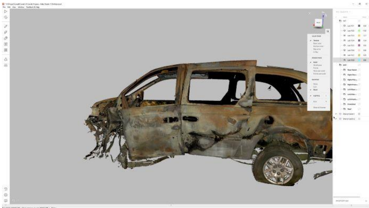
Anzeige eines Dodge Minivans Scans des Artec Leo in der Artec Studio Software
