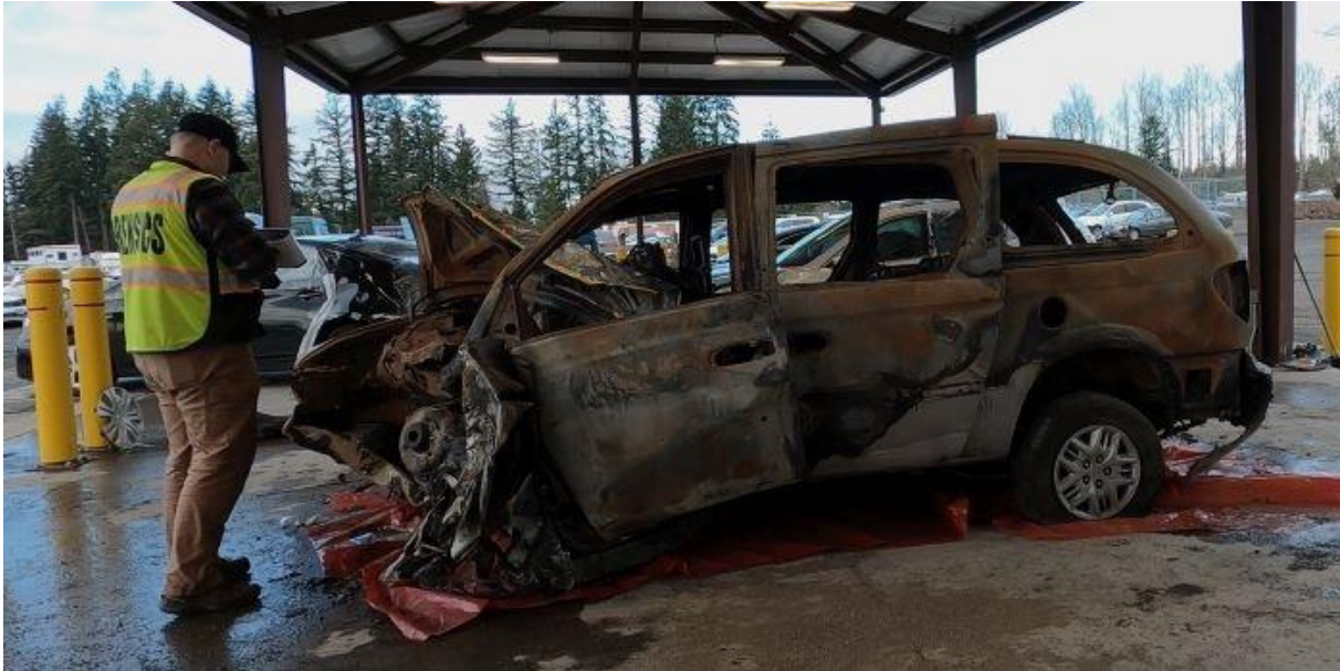
Carter scannt einen Dodge Minivan mit dem Artec Leo 3D-Scanner
