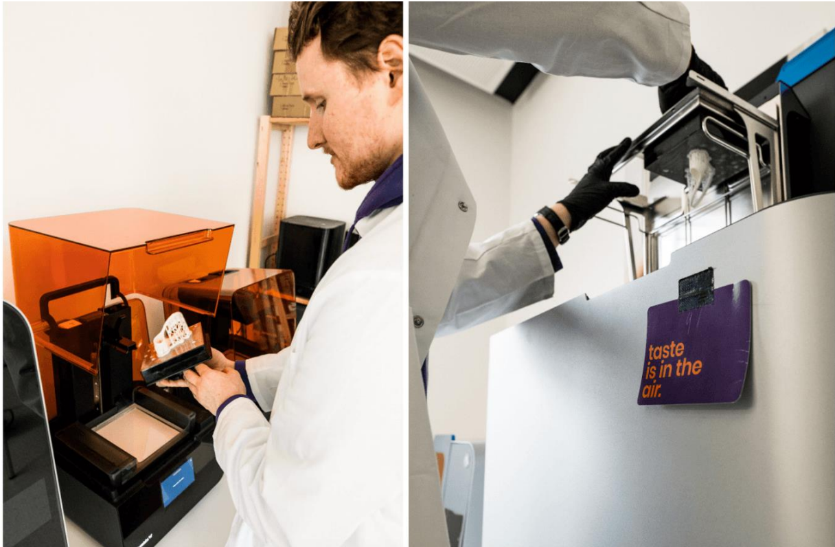
Prototyp aus White Resin, hergestellt mit dem Formlabs Form 3+ und gewaschen im Formlabs Form Wash L
