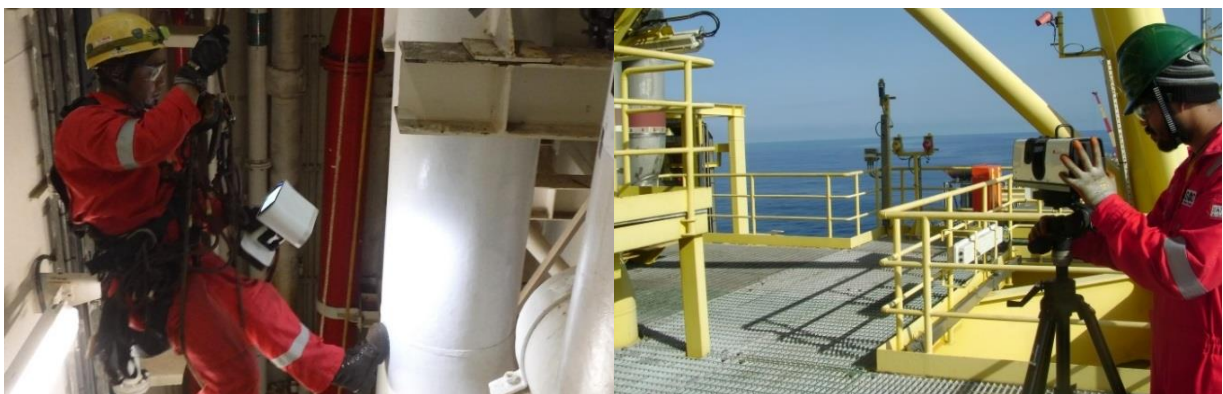
Das beschädigte Rohr und dessen Umgebung werden mit den 3D-Scannern Artec Leo und Artec Ray gescannt. Quelle: ASOM
